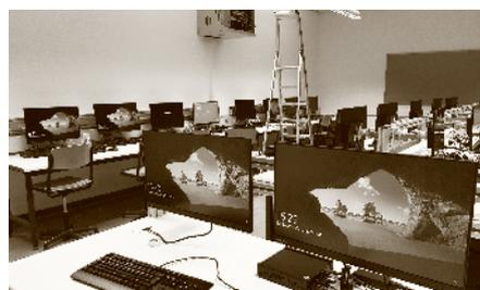
Elektrik wurde ebenso ausgetauscht wie die Netzwerk-Verkabelung. Beide Räume sind nun, an der Stelle dutzender Kupferkabel von 1996, mit jeweils 3 Glasfasern á 10 GBit an den Server angeschlossen. Die Anordnung der Tische wurde überarbeitet, so dass mehr Lern-Plätze entstanden sind, bei denen der Flachbildschirm mit einer VESA-Halterung ergonomisch verstellbar am Tisch befestigt ist und der Rechner samt der Verbindungskabel hinter dem Bildschirm verschwindet.
